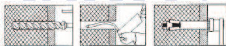
Figura D.13 — Exemplo de ancoragem mecânica
