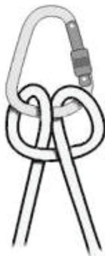
Figura D.10 — Volta do fiel
