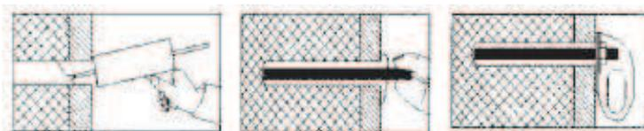
Figura D.14 — Exemplo de ancoragem química
